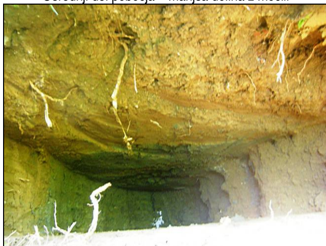
Sondažni razkop R1: zgoraj humus in rjava glina z gruščem (nasip), spodaj modrozeleni meljasta glina z vložki peska in prod, pojav vode na 2,5 m.
