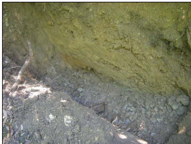
Sondažni razkop R3: zgoraj humus in rjava zbita glina, spodaj preperel flišni peščenjak.
