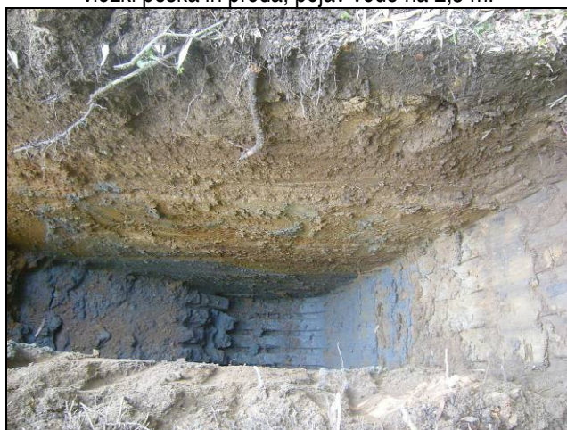
Sondažni razkop R2: zgoraj humus in rjava glina, spodaj okerjava in sivomodra meljasta glina v vložki prod in peska.
