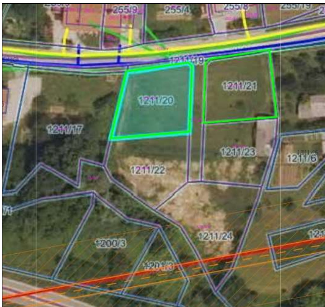
Slika št.7: prikaz obravnavanega območja in daljnoveoda DV 110kV Gorica-Ajdovščina z varovalnim pasom določenim v 55. členu OPN
