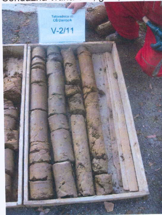
Sondažna vrtina V-2, gl. 4,0 – 8,0 m
