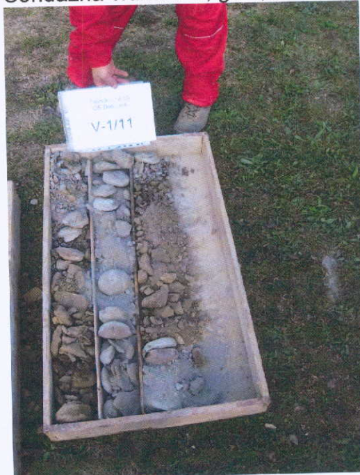
Sondažna vrtina V-1, gl. 4,0 – 7,0 m
