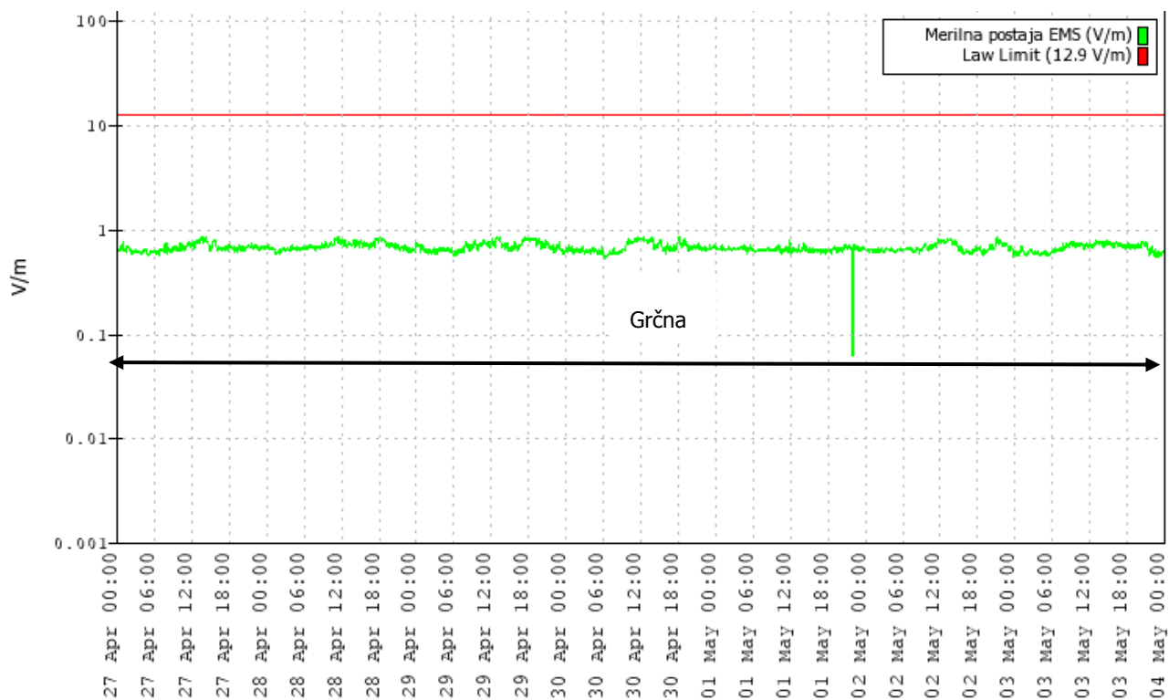
Slika 5. Prikaz rezultatov meritev električne poljske jakosti v občini Nova Gorica v obdobju od 26.4. do 3.5. 2006 na meteorološki postaji Grčna
